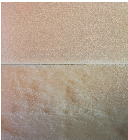
Bild 2. Demonstratorbauteile: ohne Oberflächendefekte (oben) und bedingt durch einen zu hohen Anteil Altpulver mit Oberflächendefekten (unten) © GS-Pro GmbH
